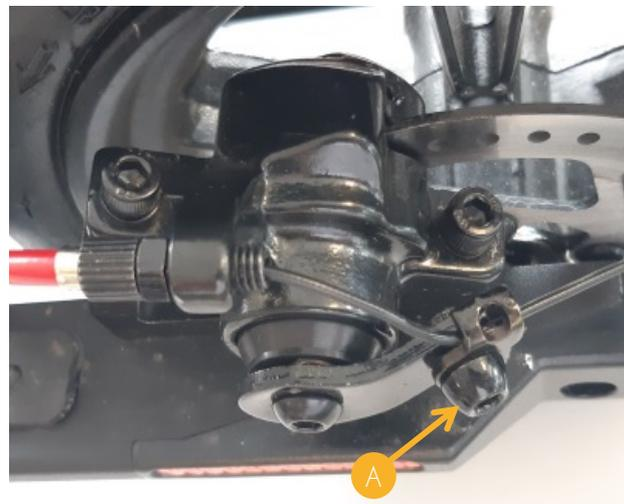
Retirer le câble de la vis de réglage suivant la flèche rouge.
