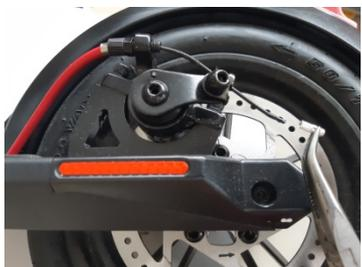
A l'aide d'un pince, saisissez l'embout et tirez vers l'arrière pour le débrancher du câble.
