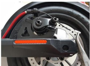
A l'aide d'une pince, saisir l'embout et tirez vers l'arrière pour le débrancher du câble.
