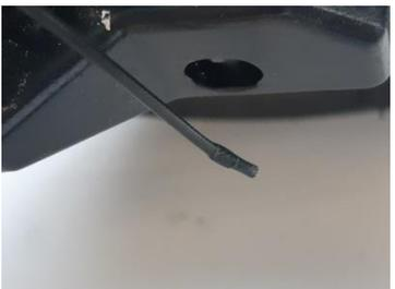
Le câble est désormais sans embout, il pourra coulisser à travers la gaine et les conduits de fixation.
